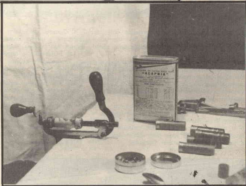
Fig. 5 - La cartuccia, dopo il caricamento, viene inserita tra le ganasce della apposita macchinetta orlatrice per la chiusura.
